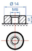
F11 (Schraubanschluss M6)
