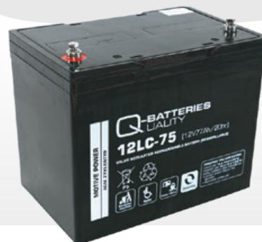
Bei der Q-Batteries LC-Serie handelt es sich um AGM-Akkus (Blei-Vlies-Technologie), die speziell für den zyklischen Einsatz konzipiert wurden. Durch den Einsatz spezieller Blei-Platten und der Verwendung eines besonderen Elektrolyts, weisen die Akkus eine besonders hohe Lebensdauer und Zyklenfestigkeit auf.
